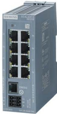
SCALANCE XB208 commutateur Layer 2 IE Switch 8x ports RJ45 10/100 Mbit/s 1x port console ; LED de diagnostic alimentation redondante certifié IEC 62443-4-2 ; plage de température 0°C à +60°C ; montage sur rail DIN ; PROFINET par défaut.
