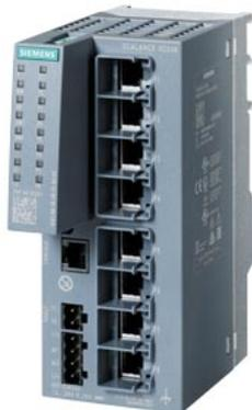
SCALANCE XC208 Layer 2 IE Switch manageable; certifié IEC 62443-4-2 ; 8x ports RJ45 10/100 Mbit/s ; 1x port console ; LED de diagnostic ; alim. redondante ; plage de température -40 °C à +70 °C ; montage : sur rail DIN symétrique/profilé support S7/mural fonctions de redondance ; fonctions Office (RSTP, VLAN,...) ; périphérique PROFINET IO Ethernet/conforme IP trappe C-PLUG.
