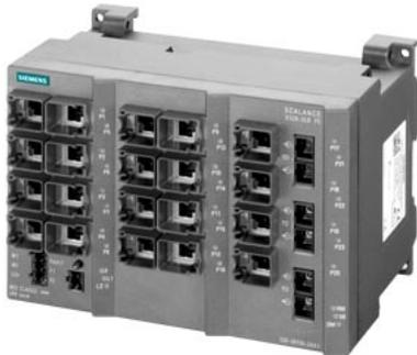
SCALANCE X320-3LDFE managed IE Switch, 20x 10/100 Mbit/s ports RJ45, 1x 100 Mbit/s SC port MM 2x ports SC 100 Mbit/s SM, diagnostic par LED, contact de signalisation de défaut avec bouton Select/Set, périphérique PROFINET IO, gestion de réseau, gestionnaire de redondance intégré, fonctionnalités Office (RSTP, VLAN, IGMP,...) C-PLUG fourni à l'étendue de la livraison.
