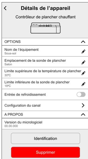
**IMPORTANT:** Si le canal UFH est affecté à l'un des appareils de chauffage suivants, vérifiez que le commutateur à bascule **Réglages de la pièce > à l'exclusion du refroidissement** est activé. Cela peut être utile s'il y a des zones dans un bâtiment qui ne nécessitent pas de refroidissement, telles que des salles de stockage ou des espaces inoccupés.
