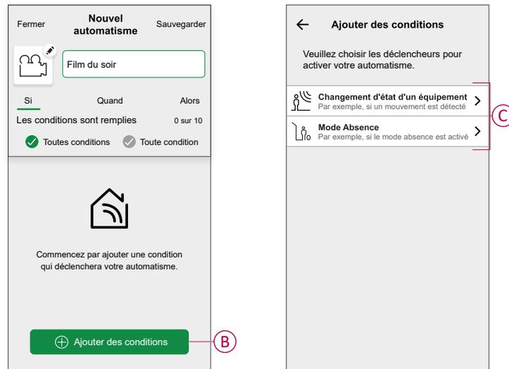
a. Dans cet exemple, nous allons sélectionner **Changement d'état d'un appareil** et choisir un appareil pour définir la condition. Ensuite, nous sélectionnerons l'état de l'appareil qui déclenchera l'automatisme, tel que l'état fermé d'un interrupteur de commande de stores.
