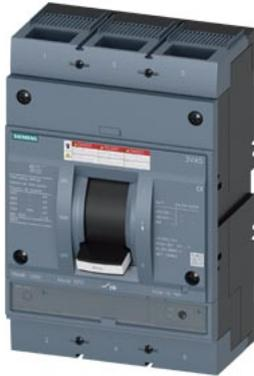
disjoncteur 3VA5 UL frame 800 classe de coupure M 35kA à 480 V 3 pôles, protection des installations TM230, FTAM, In=800A protection contre les surcharges Ir=800A à réglage fixe protection contre les courts-circuits li=5...10 x In UL489 SB (naval), 50° Cel. plage de raccordement par vis
