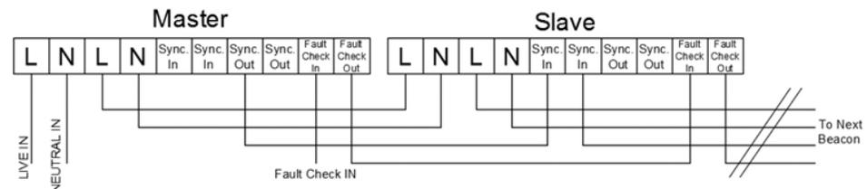
Pour le fonctionnement synchronisé de 2 balises ou plus, la connexion ci-dessus est nécessaire en utilisant l'arrangement Master/Slave.
