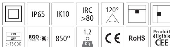
Hublot IK10, avec préavis d'extinction, utilisable en intérieur comme en extérieur (IP65), de 120 lm/W environ et résistant au test au fil incandescent de 850°C. Grâce à son bornier de connexion rapide permettant le repiquage, et ses vis 'antivol' pré-fixées dans le produit, son installation est extrêmement simplifiée.
