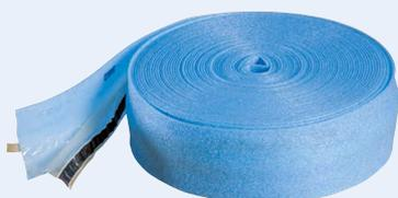
**Efirive** est une bande périphérique en polyéthylène avec une jupe adhésive pour les chapes flottantes sur l'isolant **TMS**. Elle assure en une seule opération la désolidarisation de la chape flottante par rapport aux parois et l'étanchéité au passage de la laitance grâce à sa jupe adhésive venant en recouvrement sur l'isolant.
