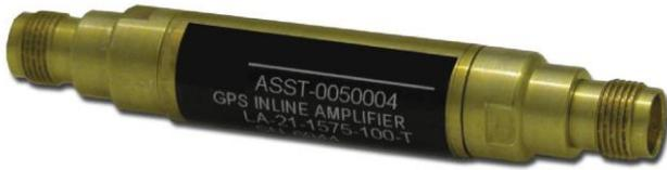
Ces amplificateurs en ligne peuvent amplifier les fréquences L1 et L2. Ils peuvent aussi augmenter les performances des récepteurs branchés sur des câbles de plus de 15m. Ils sont disponibles avec des connecteurs TNC et aucun câblage particulier n'est nécessaire pour une installation simple.
