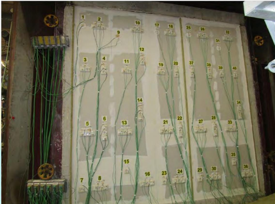
Échantillon d'essai après la simulation d'incendie d'une durée de 95 minutes
