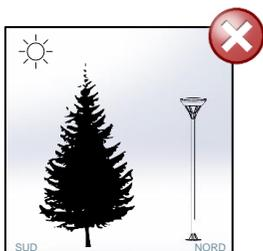
Ne pas installer le luminaire derrière ou sous un obstacle pouvant apporter de l'ombre (arbre, bâtiment...).
