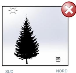
Ne pas installer la balise derrière ou sous un obstacle pouvant apporter de l'ombre (arbre, bâtiment...).
