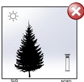
Ne pas installer la borne derrière ou sous un obstacle pouvant apporter de l'ombre (arbre, bâtiment...).
