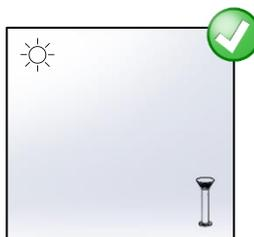
Installer le luminaire dans une zone suffisamment dégagée, pour garantir une exposition d'au moins 7 heures au soleil, nécessaire à la recharge de la batterie.
