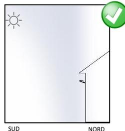
Installer le luminaire dans une zone suffisamment dégagée, pour garantir une exposition d'au moins 7 heures au soleil, nécessaire à la recharge de la batterie.
