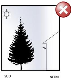
Ne pas installer le projecteur derrière ou sous un obstacle pouvant apporter de l'ombre (arbre, bâtiment...).
