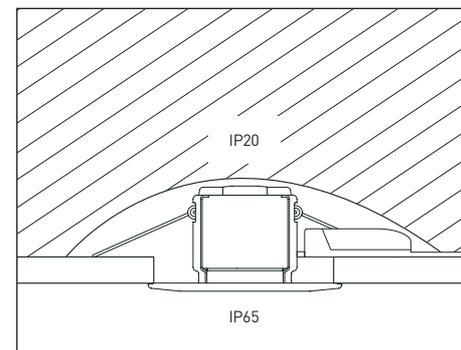
\* Ce produit peut être placé sous tous les isolants roulés et soufflés ayant un avis technique valide délivré par le CSTB (centre scientifique et technique du bâtiment).
