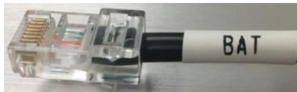
Figure 8 – Câble de communication Pylontech à insérer dans l'entrée de communication de la batterie
