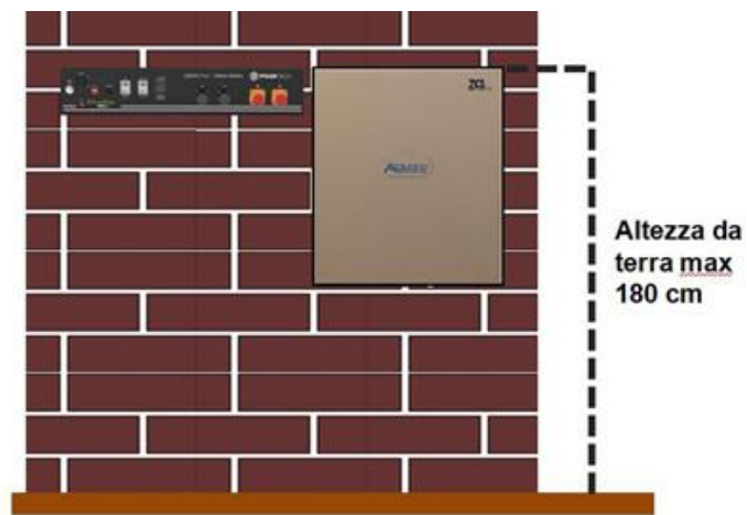
Figure 5 – Instructions pour l'installation de l'onduleur de stockage et des groupes de batteries
