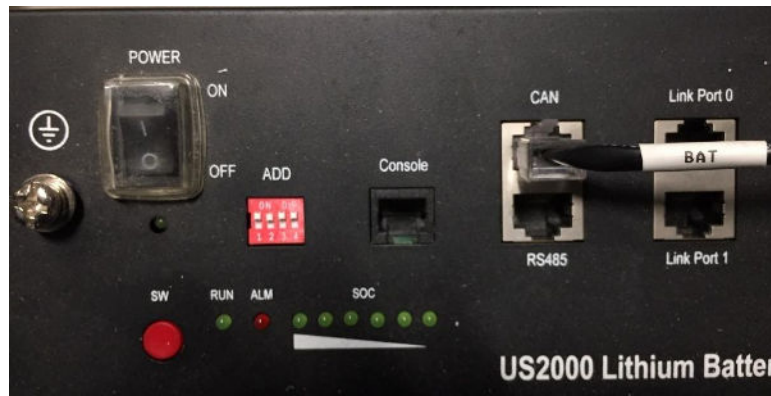
Figure 9 - Connexion du câble de communication à la batterie Pylontech
