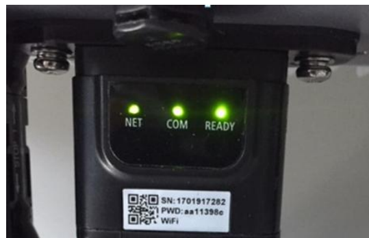
Figure 90 – État final des LED
