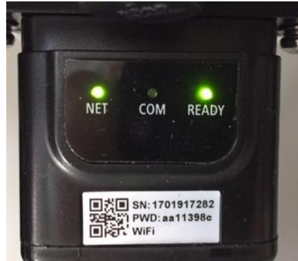
Figure 91 – État de communication irrégulière entre onduleur et adaptateur
