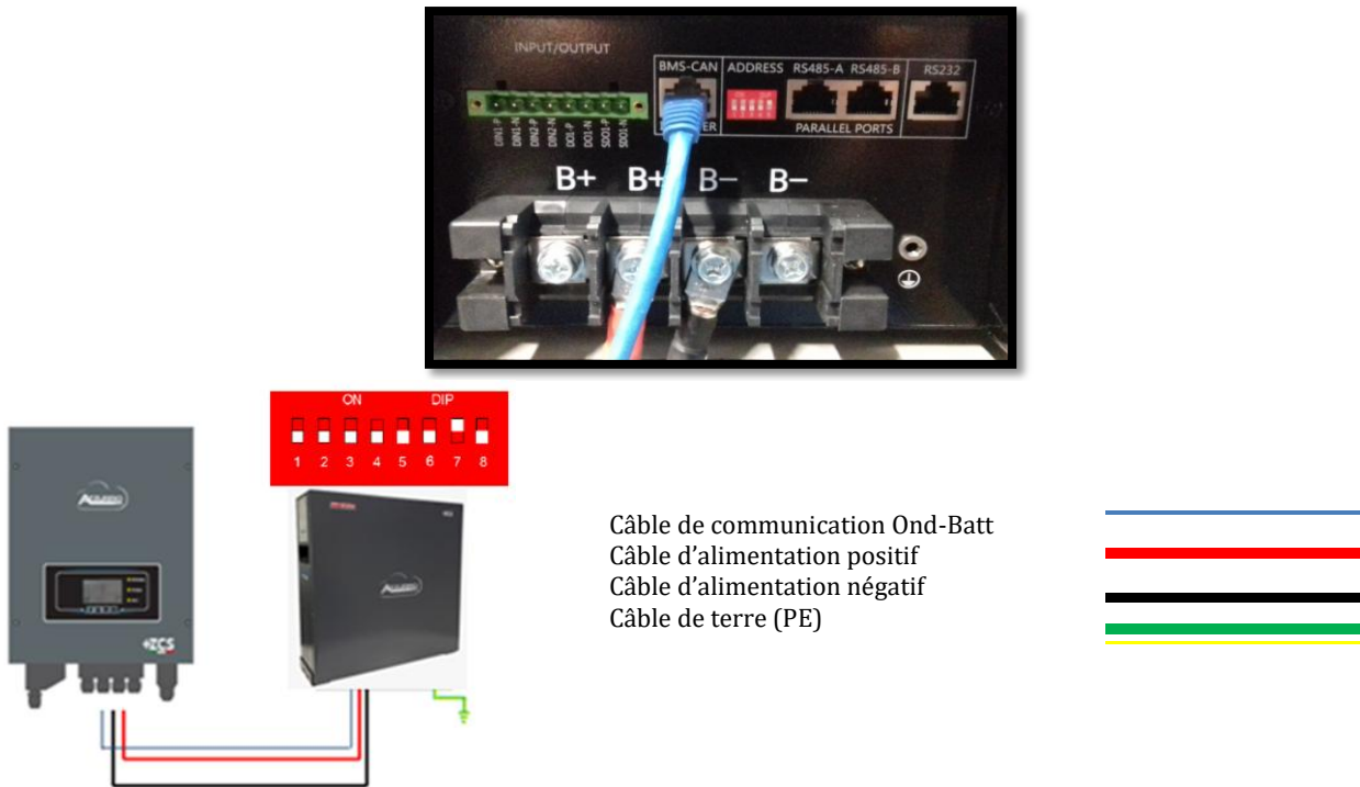
Figure 20 – Raccordement de la batterie WeCo 4k4 PRO
