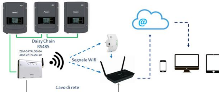
Figure 93 – Schéma de connexion du datalogger ZSM-DATALOG-04 / ZSM-DATALOG-10
