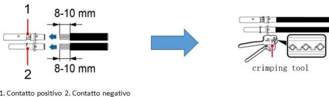
Figure 41 – Préparation des câbles photovoltaïques positif et négatif
