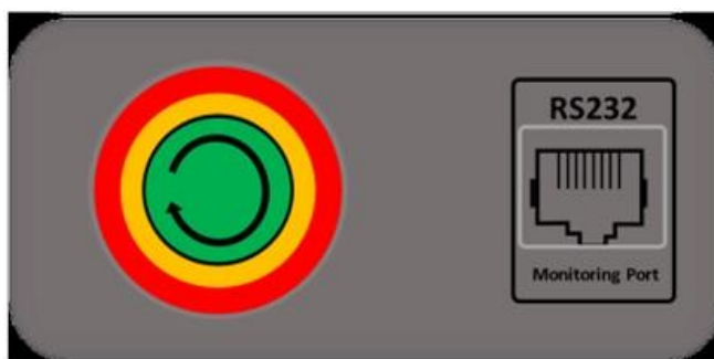
Figure 51 – Vue du bouton d'allumage de la batterie WeCo
