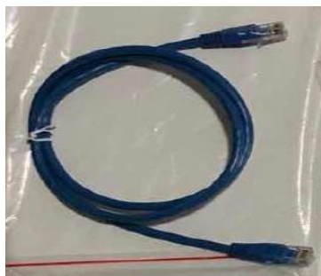
Figure 14 – Câble de communication entre batteries WeCo 4k4
