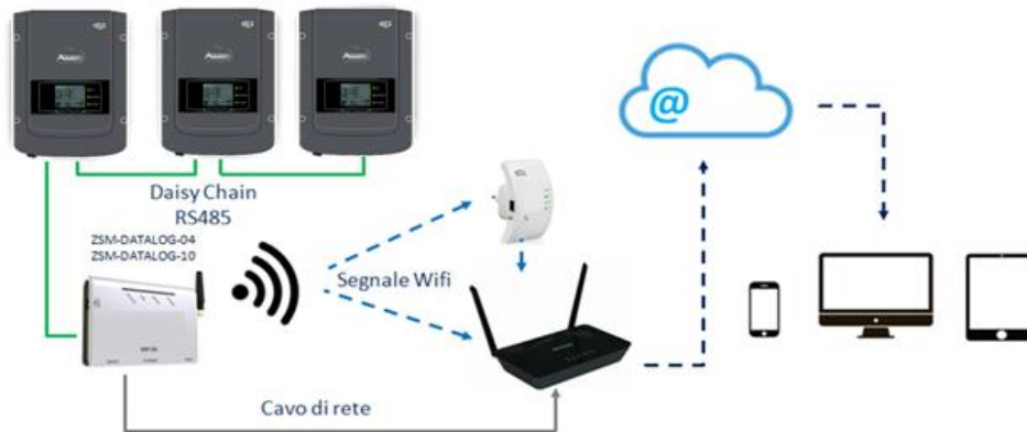
Figure 93 – Schéma de connexion du datalogger ZSM-DATALOG-04 / ZSM-DATALOG-10
