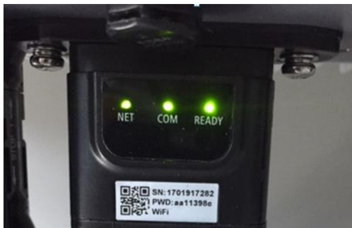
Figure 84 – État final des LED
