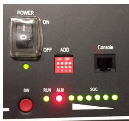
Figure 50 – État de la batterie après avoir positionné l'interrupteur POWER sur ON et appuyé sur le bouton SW
