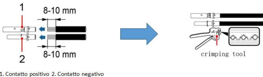
Figure 41 – Préparation des câbles photovoltaïques positif et négatif
