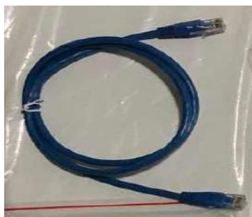
Figure 28 – Câble de communication entre batteries WeCo 5k3
