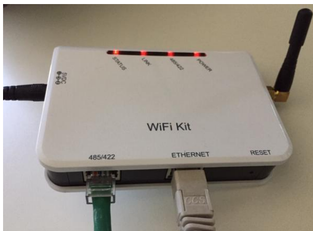
Figure 101 – Câble Ethernet connecté au datalogger
