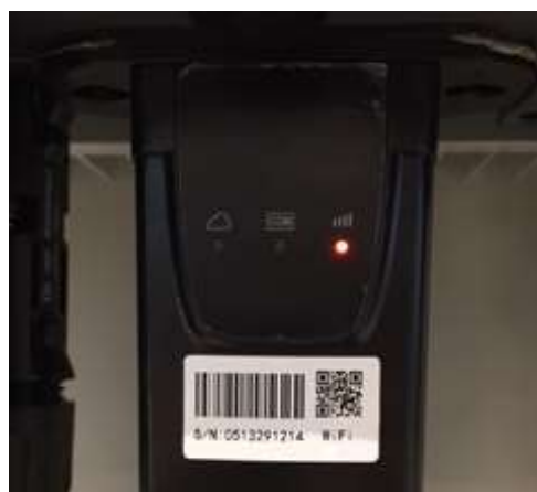
Figure 106 – État de communication irrégulière entre Wi-Fi et serveur à distance
