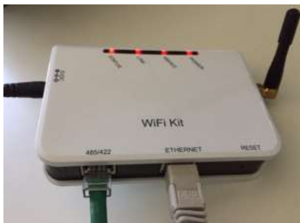
Figure 131 – Câble Ethernet connecté au datalogger
