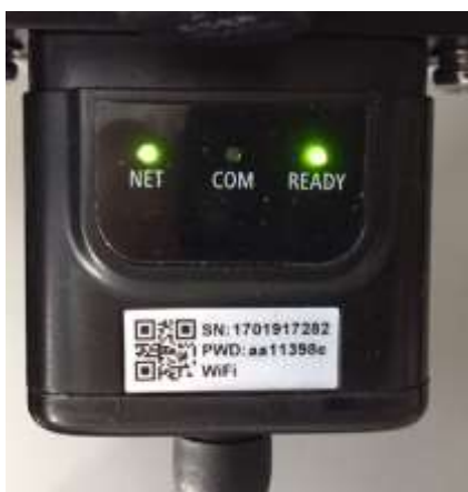
Figure 104 – État de communication irrégulière entre onduleur et Wi-Fi
