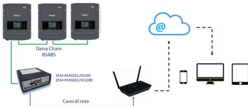
Figure 124 – Schéma fonctionnel du datalogger ZSM-RMS001/M200 / ZSM-RMS001/M1000
