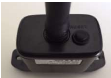
Figure 103 – Touche de réinitialisation sur la carte Wi-Fi
