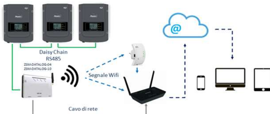
Figure 123 – Schéma de connexion du datalogger ZSM-DATALOG-04 / ZSM-DATALOG-10
