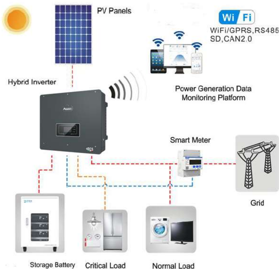
Figure 1 – Schéma de principe d'un système avec onduleur hybride 3PH HYD5000-HYD20000-ZSS
