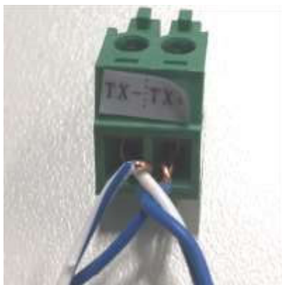
Figure 126 - Serrage du câble secteur sur le bornier RS485
