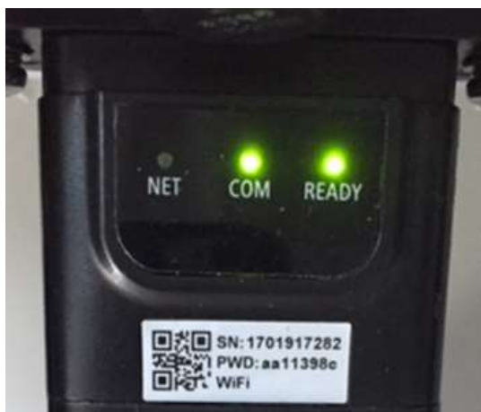
Figure 116 – État de communication irrégulière entre carte et serveur à distance
