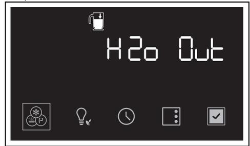
L'eau commence à couler dans la lèchefrite profonde par le tuyau de vidage, placé sur le côté droit de la paroi postérieure de la cavité de cuisson.
