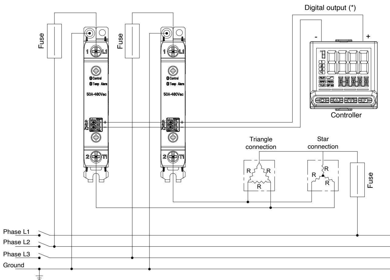
(\*) Oppure uscita relè con tensione uscita Vac (Utilizzare GRS-H con ingresso comando Vac, Tipo ingresso “A”)
