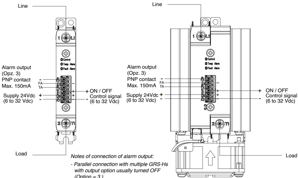
Esempio di collegamento per GRS-H con comando Vdc con opzione allarme termico (Opzione 5)
