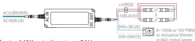
Schéma de câblage avec bouton 1-10V, potentiometre ou DALI :
