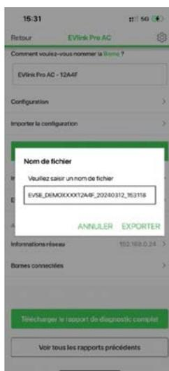
L'application eSetup m'aide pour la mise en service avec un pas à pas intuitif. De plus, s'il y a 10 bornes à installer, il est possible d'en configurer une puis d'exporter les paramètres vers les 9 bornes autres.
