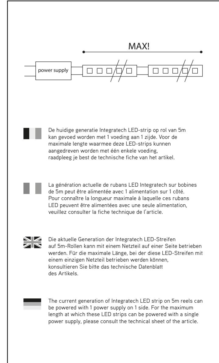
■ ■ De huidige generatie Integratech LED-strip op rol van 5m kan gevoed worden met 1 voeding aan 1 zijde. Voor de maximale lengte waarmee deze LED-strips kunnen aangedreven worden met één enkele voeding, raadpleeg je best de technische fiche van het artikel.
