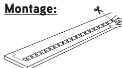
Controleer steeds voor de montage of alle secties van de LED-strip correct functioneren! LED-strips met een vermogen hoger dan 5W per meter moeten altijd in een aluminium LED-profiel van Integratech gemonteerd worden. Aluminium profielen voor LED-strips bestaan uit een specifieke legering (AL606\* Al-Mg-Si) die uitzetten/krimpen minimaliseert bij temperatuursschommelingen. Raadpleeg onze catalogus voor LED-strip/LED-profiel combinaties.
