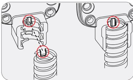
À la remise en place, bien positionner l'encoche de la gaine dans l'ergot de l'embase
