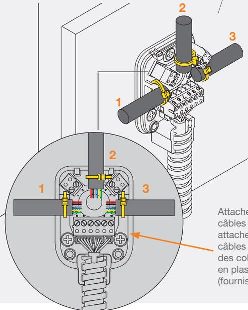
Attacher les câbles aux attaches câbles à l'aide des colliers en plastique (fournis)
