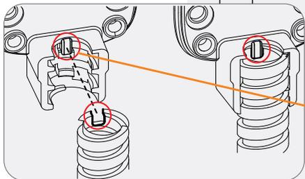
À la remise en place, bien positionner l'encoche de la gaine dans l'ergot de l'embase
