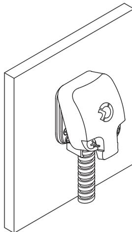
**4** Détacher le mini connecteur **A** et retirer la gaine **B**.
