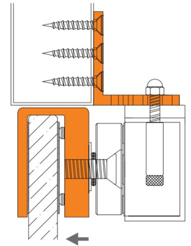
VERROUILLAGES ÉLECTRIQUES Ventouses électromagnétiques en applique
