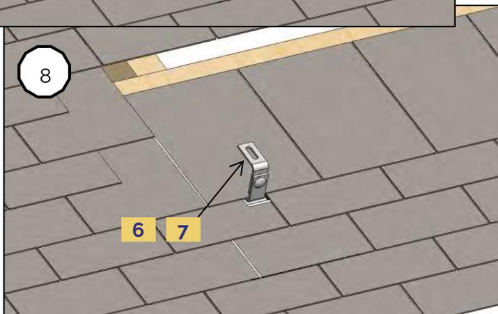
Repose des ardoises sur et autour des crochets.
