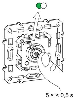
La lumière connectée au variateur rotatif clignote quelques fois. La LED d'état cesse de clignoter en vert sur l'interrupteur sans fil et le variateur rotatif. Le variateur rotatif peut désormais être commandé par l'interrupteur sans fil.
