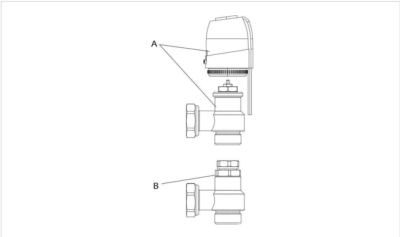
**A** Vanne automatique avec tête thermoélectrique
