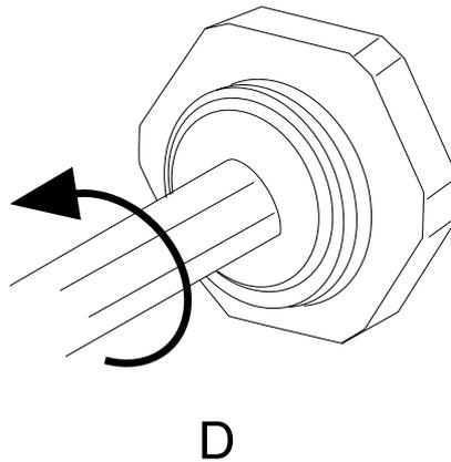
Le pré réglage est maintenant défini et ne changera pas, même après l'ouverture et la fermeture à l'aide de la clé Allen.
