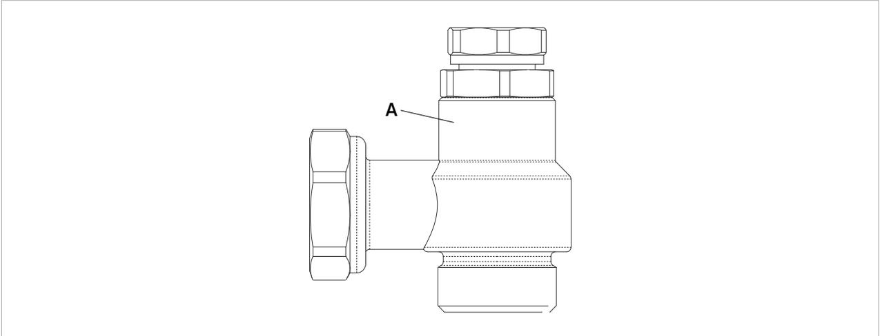
• Utilisez un tournevis pour desserrer et retirer la vis pointeau à tête fendue à l'intérieur de la tête hexagonale.
