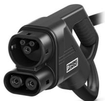
CHARX connect standard, CCS type 2, Câble de charge DC, jusqu'à 500 A dans Boost mode, 200 A permanent, 1000 V DC, avec connecteur de charge côté véhicule et extrémité de câble libre, câble: 8 m, noir, droit, avec contact PP raccordé, avec cadre d'enfichage échangeable, avec capteurs de température analogiques, Logo PHOENIX CONTACT, IMPORTANT : gestion de câbles requise le cas échéant., CEI 62196-3, pour la charge en courant continu (DC) des véhicules électriques (VE)
