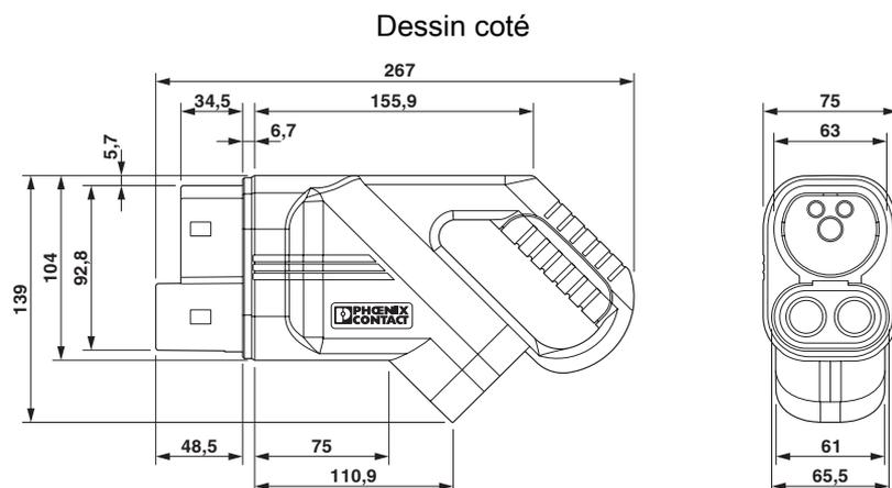
S'assurer que le connecteur de charge côté véhicule est enfiché pendant toute la durée de l'arrêt du chargement dans un support de connecteur de charge adapté, qui assure une protection minimale IP24 selon la norme CEI 61851-1. Pour fabriquer un tel support de connecteur de charge, utilisez les dimensions du connecteur de charge côté véhicule. Vous trouverez également des dimensions détaillées dans la zone des téléchargements.
