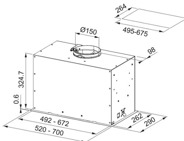
Groupe aspirant BOX PLUS 520 mm inox, classe B, débit max 540 m<sup>3</sup>/h/int 620 m<sup>3</sup>/h, niveau sonore mini 47 dB (A)/maxi 64 dB(A), commandes boutons, 3 vitesses + intensif, aspiration périphérique
