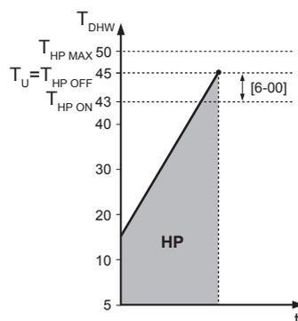
**HP** Pompe à chaleur. si la durée de chauffage de la pompe à chaleur est trop longue, un chauffage auxiliaire peut être produit par le chauffage d'appoint
