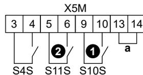
a Fil de liaison (installé en usine). Si vous raccordez également un thermostat de sécurité (Q4L), remplacez le fil de liaison par les fils du thermostat de sécurité.
