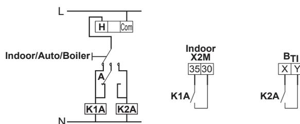
**B<sub>T1</sub>** Entrée du thermostat de la chaudière
