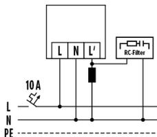
Raccordement d'inductances (par ex. relais, contacteur, ballast) peut nécessiter l'insertion d'un filtre RC (RC-Filter).
