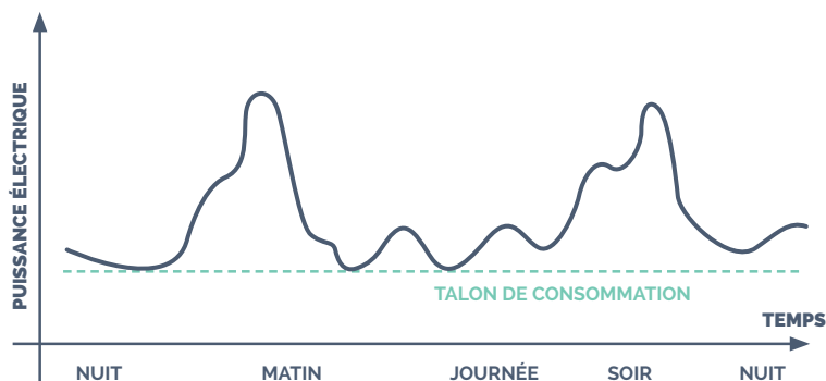
FIG.3 : Talon de consommation électrique d'un foyer
