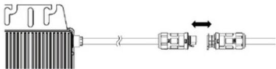
Connectez le câble du micro-onduleur à celui du panneau en plug & play.
