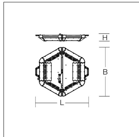
Großflächenleuchte. Gehäuse Aluminium pulverbeschichtet. Ecken geschützt durch Kunststoffkappen. Hocheffiziente LED-Einheiten mit optimaler Lichtlenkung durch präzise Linsenoptik aus Kunststoff (PC) klar. Zusammengeklappt auf dem Boden, aufgeklappt auf Stativ oder hängend einsetzbar. Dimmbar mit Potentiometer. Inkl. Adapter für Zapfen-Aufnahme (d=30 mm, DIN 14640) mit der Möglichkeit einer geraden oder 30° geneigten Montage. Inkl. Husse zum Schutz und Aufnahme der Zuleitung beim Transport.
