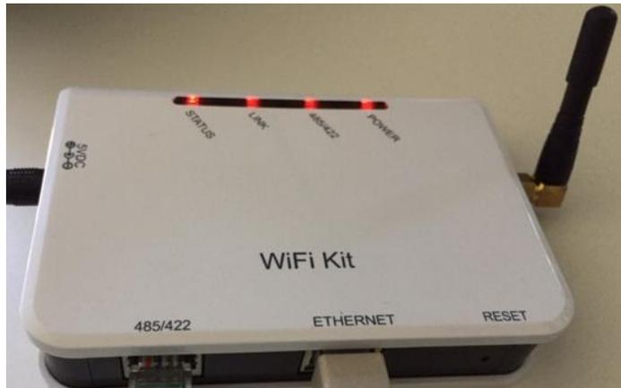
Figure 20 - Led qui indique la configuration correcte du datalogger
