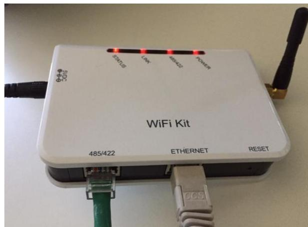
Figure 7 - Câble Ethernet connecté au datalogger
