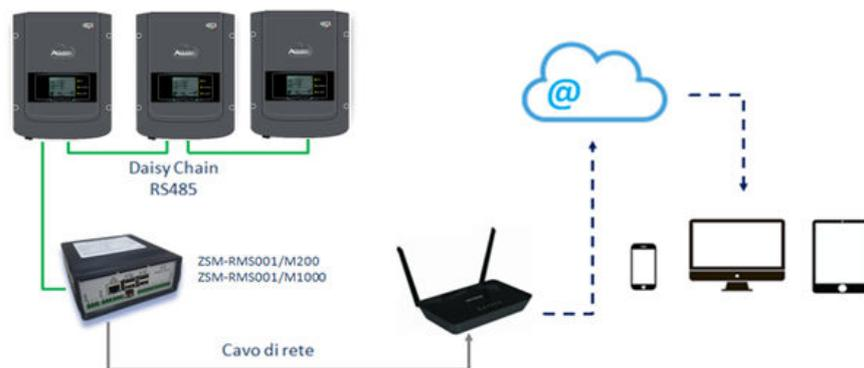
Figure 2 - Schéma fonctionnel du datalogger ZSM-RMS001/M200 / ZSM-RMS001/M1000
