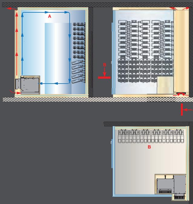
Installer un espace cave climatisé dans un living room ou une pièce de loisir devient relativement simple avec le **MPCA**. Posé sur une rehausse **KRH**-... dans le local, il se branche sur une prise de courant.
