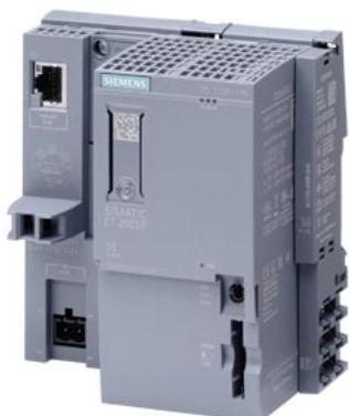
SIMATIC DP, CPU 1512SP F-1 PN pour ET 200SP, module unité centrale avec 600 Ko de mémoire de travail pour le programme et 2 Mo pour les données, 1re interface : PROFINET IRT avec commutateur 3 ports, 25 ns performance sur bit, SIMATIC Memory carte mémoire nécessaire, adaptateur de bus nécessaire pour port 1 et 2
