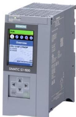
SIMATIC S7-1500F, CPU 1516F-3 PN/DP, CPU avec 3 Mo de mémoire de travail pour le programme et 7,5 Mo pour les données, 1ère interface : PROFINET IRT avec commutateur 2 ports, 2ème interface : PROFINET RT, 3ème interface : PROFIBUS, performance sur bit 6 ns, SIMATIC Memory Card nécessaire
