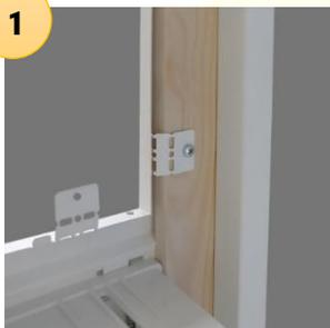
1. Placer le cadre de la trappe au-dessus du bac, en insérant les barrettes de liaison dans les encoches prévues à cet effet. Verrouiller les pattes à l'aide des vis.
