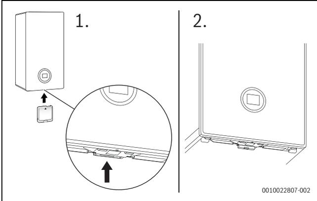
Fig. 4 Position de l'emplacement de la Clé RF
