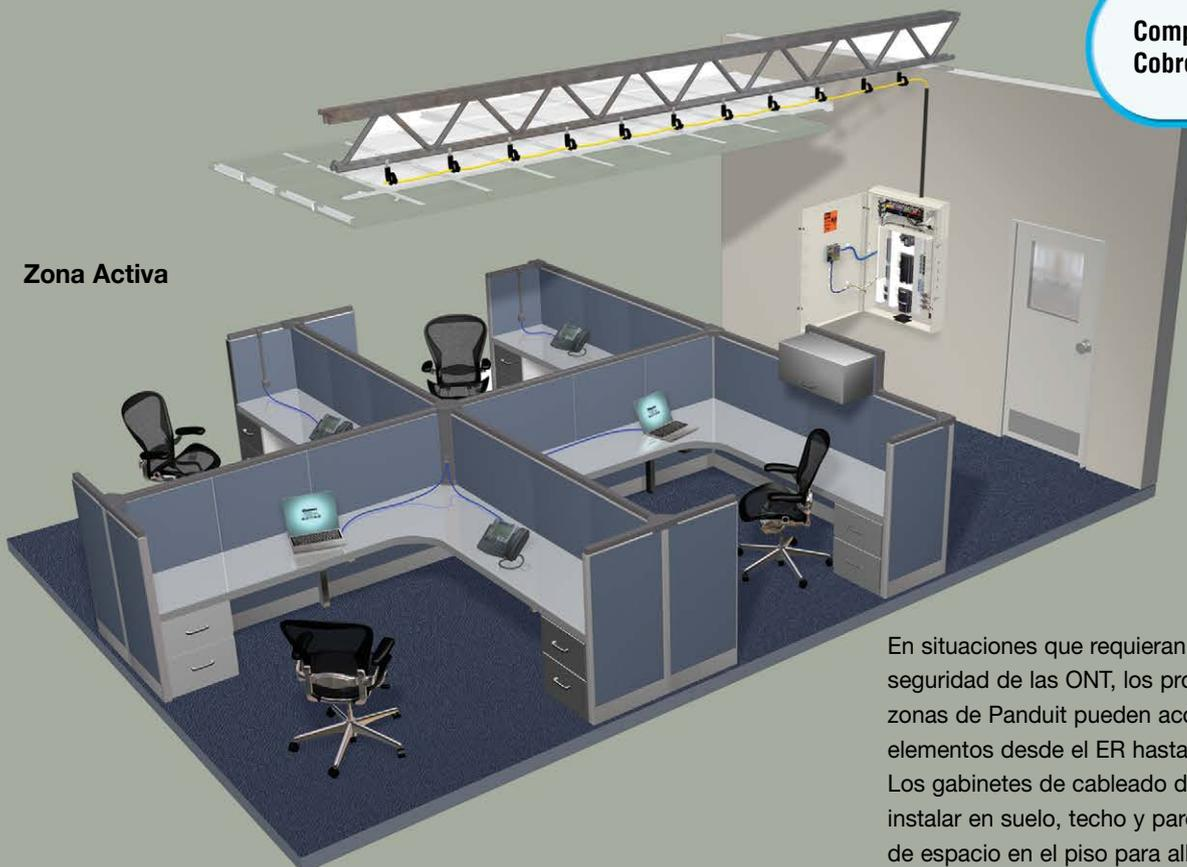
En situaciones que requieran aislamiento físico/ seguridad de las ONT, los productos de cableado por zonas de Panduit pueden acomodar todos los elementos desde el ER hasta las áreas de trabajo (WA). Los gabinetes de cableado de zona activos se pueden instalar en suelo, techo y pared y excluyen la necesidad de espacio en el piso para albergar y asegurar ONTs.
