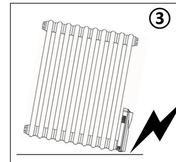
**IMPORTANT** Le boîtier ne doit pas reposer sur le sol (voir figure ③). Veuillez prévoir des cales lors de l'installation.
