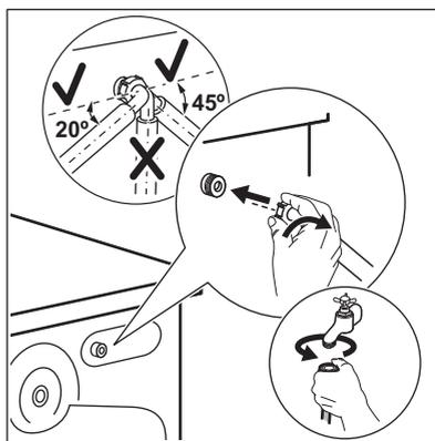
2. Placez-le vers la droite ou la gauche, en fonction de la position de votre robinet d'eau. Assurez-vous que le tuyau d'arrivée d'eau n'est pas en position verticale.
