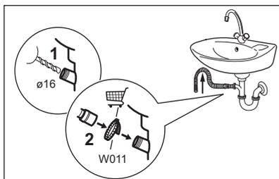
Raccordez le tuyau de vidange au siphon et serrez-le avec une attache. Veillez à ce que le tuyau de vidange fasse une boucle afin d'éviter que des particules passent de l'évier à l'appareil.
