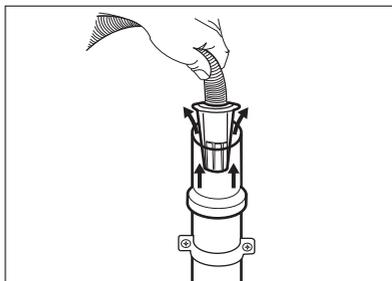
3. À une conduite fixe dotée d'une ventilation spéciale : insérez directement le tuyau dans le tuyau de vidange. Reportez-vous à l'illustration.
