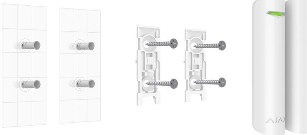
1. Fixez les panneaux de fixation du SmartBracket et l'aimant à l'aide des vis groupées. Si vous utilisez d'autres pièces de fixation, assurez-vous qu'elles n'endommagent ni ne déforment le panneau.
