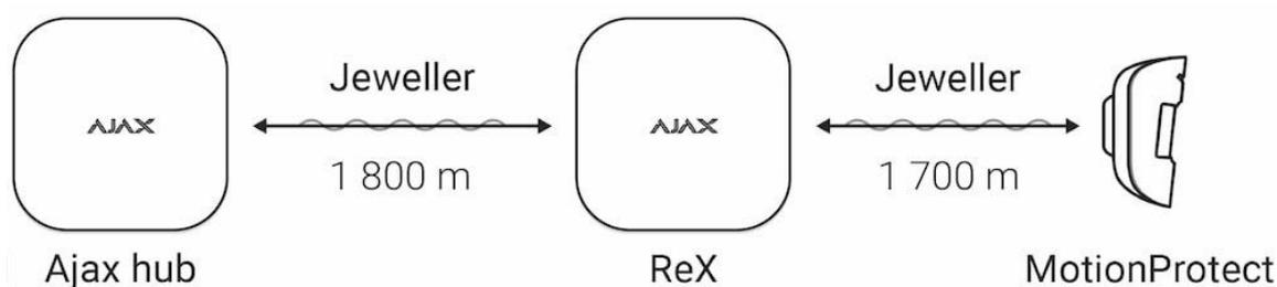
La portée de la communication entre ReX et l'appareil est limitée par la portée du signal radio de l'appareil (indiquée dans les spécifications de l'appareil sur le site web et dans le manuel de l'utilisateur).
