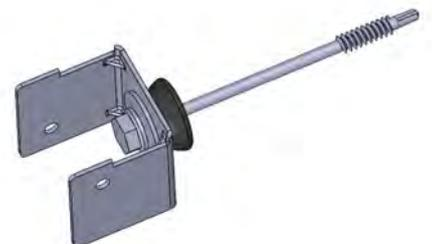
Ajout de la vis pour montage : support, cloche, rondelle, vis
